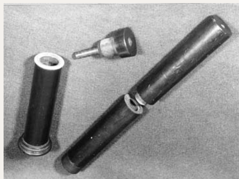
FIGURE II « Je me sers actuellement d'un cylindre de bois percé dans son centre et brisé au milieu, à l'aide d'une vis afin de le rendre plus portable ». © D. R. (Extrait de la collection du Palais de la découverte.)
