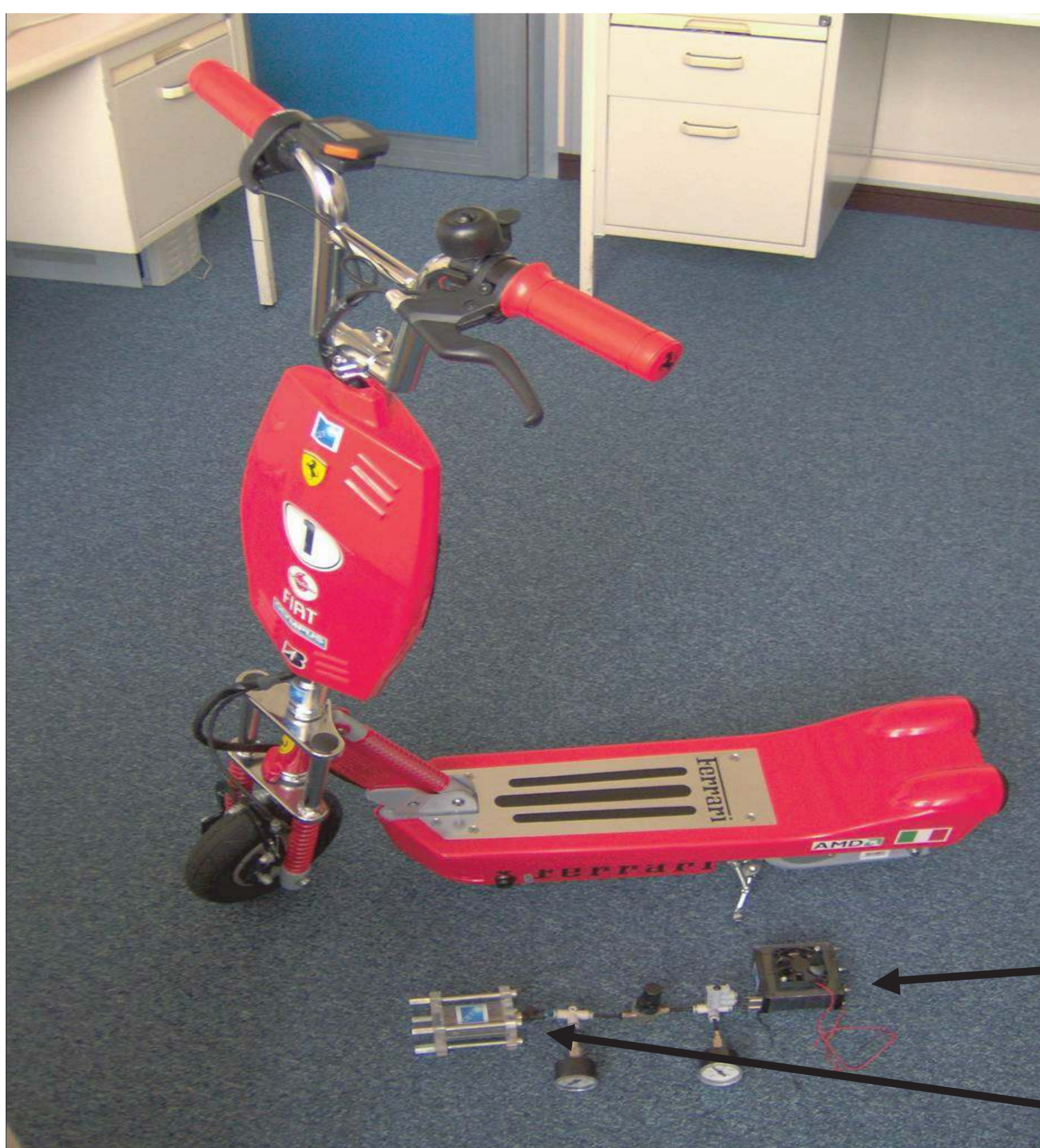
Figure 3 : TrotHynet® à pile à combustible avec alimentation en hydrogène par un réservoir d'hydrure métallique
