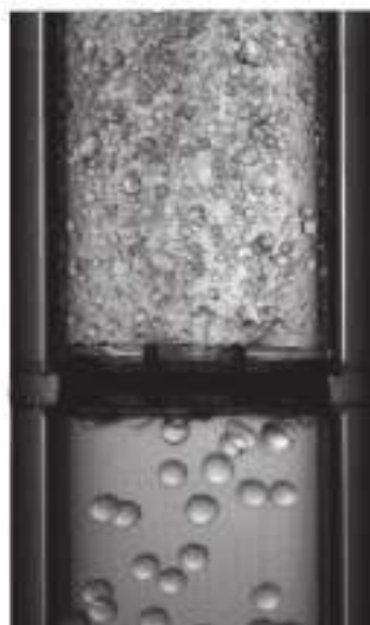
Écoulement de gouttes au travers d'un orifice : apparition de gouttes plus petites
