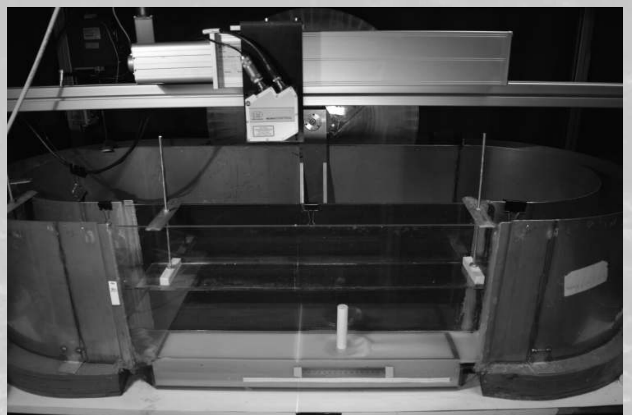
Schéma et photo du canal permettant l'étude de l'affouillement au laboratoire FAST à Orsay. © F. Lachaussée
