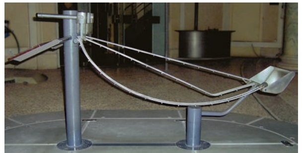
Figure 1. Cette expérience, que vous pouvez retrouver au premier étage du Palais de la découverte, permet de tester trois chemins entre deux points situés à deux altitudes différentes : un segment de droite, une ligne brisée constituée de deux segments de droite et une cycloïde. De ces trois chemins, lequel est le plus rapide ? © G. Reuiller.
