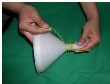
2. Faites une boucle à l'extrémité supérieure de la bobine ainsi créée et attachez-lui environ 15 cm de fil.
