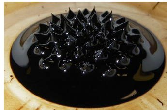
Un ferrofluide au-dessus d'un aimant au néodyme. Crédit : Steve Jurvetson / CC BY 2.0
