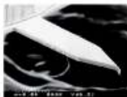
Image d'un levier et de sa pointe grossie 600 fois.
