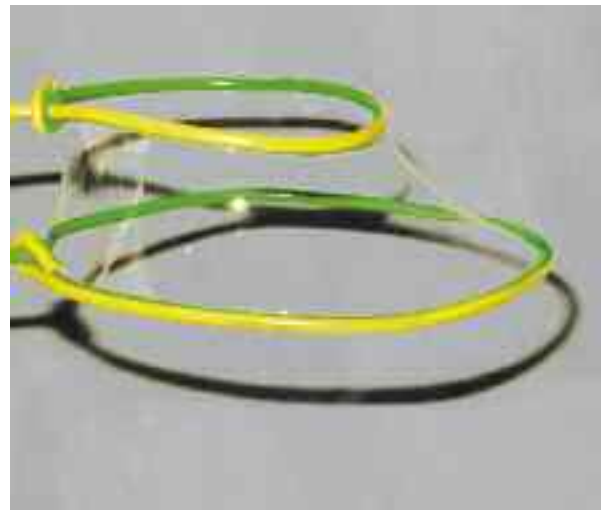
Figure 3. Si vous décalez les contours circulaires, ce n'est plus une caténoïde ! © C. Rousselin.
