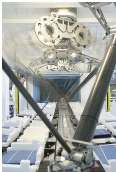
FIGURE 11 Ligne industrielle de production de cellules au silicium à Q.Cells. Source Q.Cells (Allemagne).
